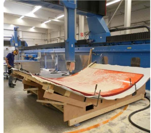
CNC-5-Achs Konturfräsung der bereits thermisch verformten Elemente bei Heinz Fritz GmbH in Herbrechtingen
